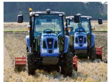
中型ロボットトラクターによる耕うん作業省力化。県・メーカーの共同開発
